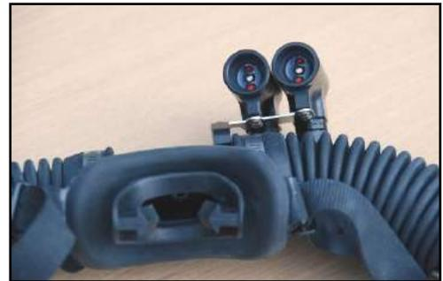
Mit Hilfe der Schlauchgewichte kann der Atemschlauch sowie das Mundstück unter Wasser in eine angenehme **Position gebracht werden**. Die HUD's sind so gestaltet das sie auf das Mundstück gesteckt werden. Eine zusätzliche Umhüllung für die Atemschläuche schützt diese vor Beschädigungen von außen. (Foto: Umhüllung nur auf dem rechten Schlauch)
