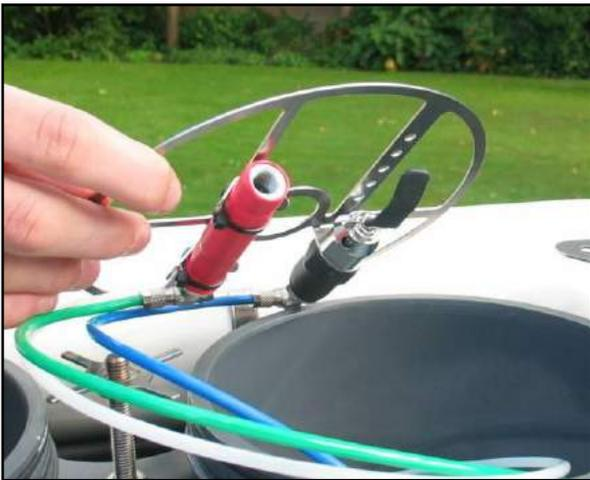
In der mCCR-Version befindet sich an der Düse ein Rückschlagventil um zu verhindern, dass Schmutz, Staub oder Feuchtigkeit aus der Ausatemgegenlung in die Düse gelangt.
