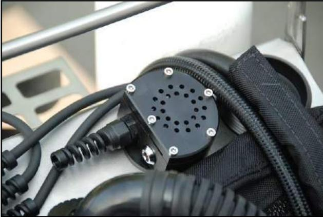
Das Überdruckventil (OPV – Over Pressure-Valve) befindet sich in der Ausatem-Gegenlung am oberen Ende des Edelstahl-Gehäuses. Dieses Ventil ermöglicht das Entweichen von überschüssigem Gas im Falle von Überdruck, wie zum Beispiel beim Auftauchen mit einem geschlossenen Mundstück (Notaufstieg mit offenem System). Der Druck bei dem das Ventil öffnet, ist vom Hersteller eingestellt und sollte nicht verändert werden. Es ist durch den Tragebügel perfekt geschützt.
