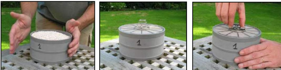
Klopfe für etwa eine Minute auf die Seite des Behälters während Du zugleich die Mutter nachziehst wenn der Kalk zusammensackt. Drehe die Mutter bis die Feder wieder komplett komprimiert ist (Nicht zu fest anziehen – der Bügel könnte sich von der Mutter lösen).
