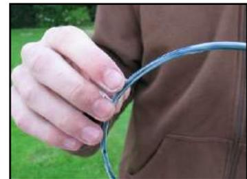
Nimm ein bisschen sauerstoffkompatibles Schmiermittel und verteile es auf dem O-Ring, indem du den Ring zwischen Daumen und Zeigefinger durchziehst. Stelle sicher, dass das Schmiermittel gleichmäßig verteilt ist. Pass auf das du nicht zu viel Schmiermittel verwendest, da der Überschuss vom Deckel beim Zusammenbau weggedrückt wird.
