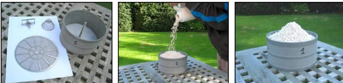
Klopfe leicht auf die Seite des Behälters, während du ihn drehst, damit sich der Absorber setzt. Sobald der Kalk eben ist und die Schraube in der Mitte wieder sichtbar, lege das Edelstahlsieb, das Gitter sowie die Feder darauf und fixiere alles mit der Mutter bis die Feder komplett zusammengedrückt ist (nicht überdrehen).
