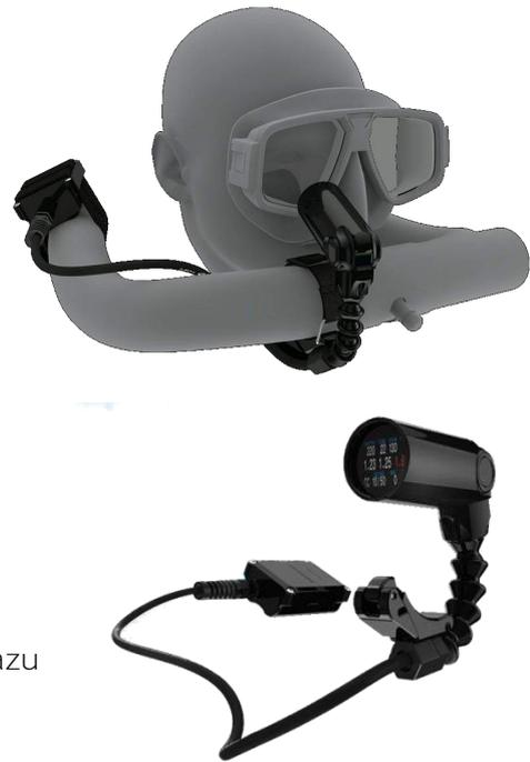
Das rEvo kann (optional) mit einem Computersystem (Shearwater Petrel oder NERD) ausgerüstet werden, der automatisch einen voreingestellten  $pO_2$  aufrechterhält. Dazu wird ein elektrisch angesteuertes automatisches Ventil (Magnetventil) parallel zu der Düse montiert. Das Magnetventil sowie die Düse werden von derselben Sauerstoffzufuhr gespeist.
