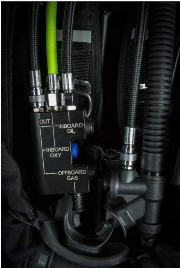
Die manuelle Zugabe von Sauerstoff, Verdünnungsgas oder einem externen Gas wird mit einem leicht erreichbaren Gasblock, mit dem drei unterschiedliche Gase bedient werden können, gewährleistet. Dieser kann mit beiden Händen bedient werden. Der Sauerstoff-Knopf ist zurückgesetzt, so können die unterschiedlichen Gase auch durch Fühlen auch mit Dicksen Handschuhen sicher identifiziert werden.
