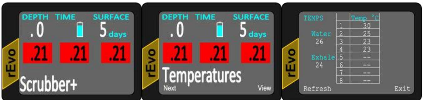
Man sieht, dass die Temperaturwerte für den ersten oberen Behälter (Temperatur 1 bis 4) angezeigt werden, aber keine Werte für Temperatur 5 bis 8, welche von den Temperatursensoren in dem unteren Kalkbehälter geliefert werden müssten.
