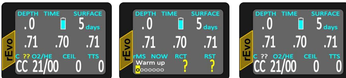
Auch der Hauptbildschirm zeigt an, ob der Kalk vollständig erwärmt ist oder nicht – solange er sich noch im Erwärmungsprozeß befindet ist der Doppelpunkt „:“ zwischen den Stunden und den Minuten der RCT Zeit gelb – ist er vollständig erwärmt, wird er grün. Zu diesem Zeitpunkt liegen rMS alle Informationen über den gesamten Atemkalk vor, um eine Vorhersage über die RCT Zeit und RST Zeit zu machen.
