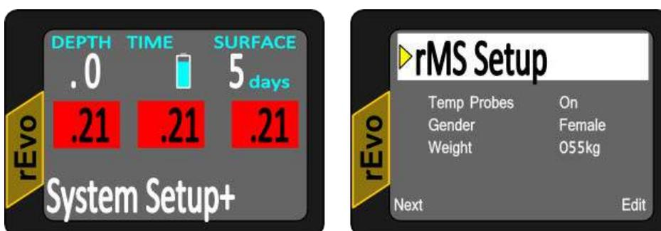
Über das rMS Setup kann man die Temperatursensoren („Temp. Probes“) ein- und ausschalten, damit wird rMS ein- und ausgeschaltet.
